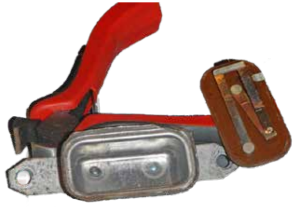
STABIL – Links seht Ihr einen thermischen Spannungsstabilisator für Land Rover. Rechts davon ist er in seine Einzelteile zerlegt. Auf der Deckelunterseite sind die Schaltkontakte und der Bi-Metall-Streifen ist gut erkennbar.
