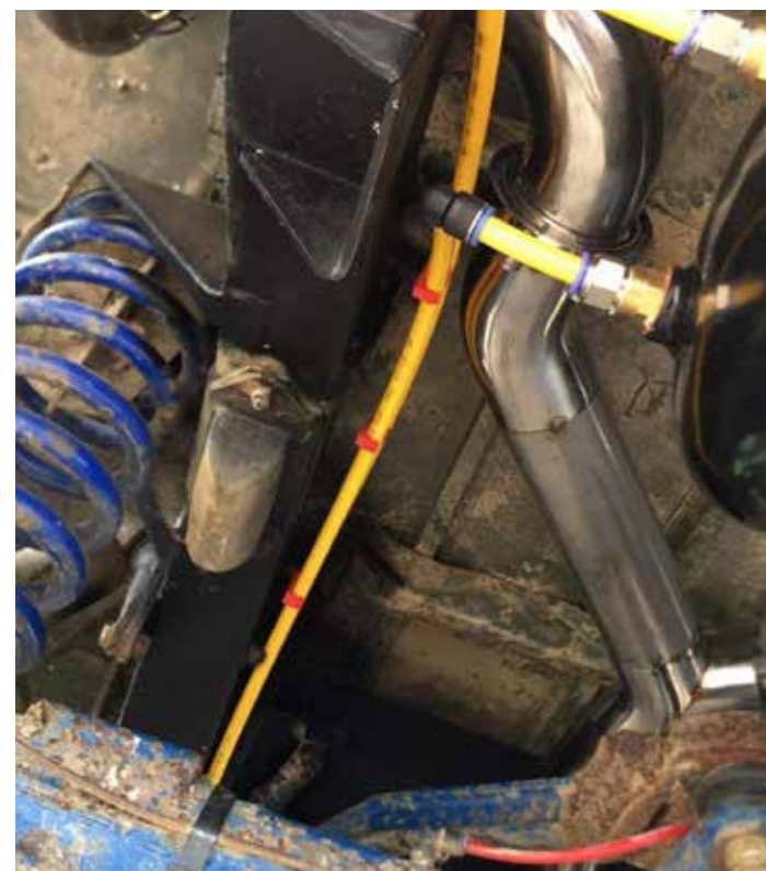
DRUCKLUFT – Gelb hält Rob die Luftdruckschläuche. So ist stets ersichtlich, wo die entsprechenden Leitungen entlangführen. Die Herausforderungen sind nicht zu unterschätzen aber lösbar. Wenn auch mit viel Einsatz und einigen Kosten. Es lohnt sich! Der 90er Cummins ist kein wirkliches Familienfahrzeug, mein weisser 130er hingegen schon.
