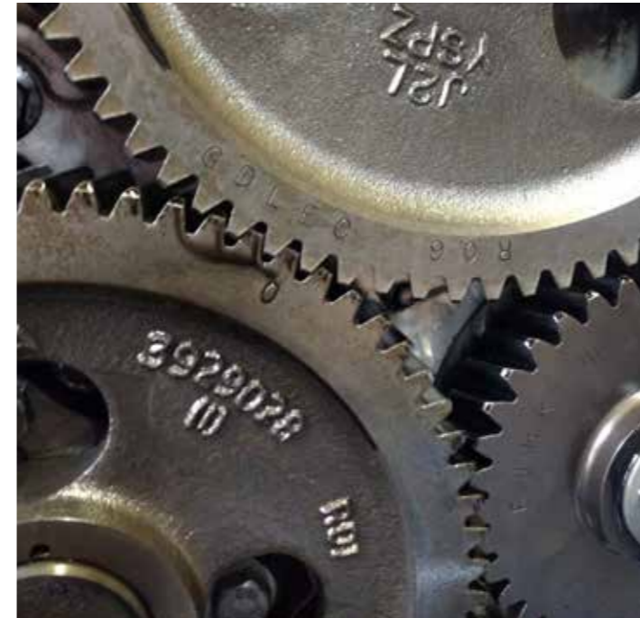
ZAHNRÄDER – Oben sieht man deutlich, welche Arbeiten im Getriebetunnel nötig waren. Rechts oben und links unten sieht Ihr dann, wie ich die einzelnen Zähne zählte, um die passende Übersetzung zu erreichen. Das Verteilergetriebe habe ich auf 1:003 umgebaut und das Timing auf C umgestellt. Unten links und rechts möchte ich Euch das Endergebnis vorstellen. Gelungen, oder?
