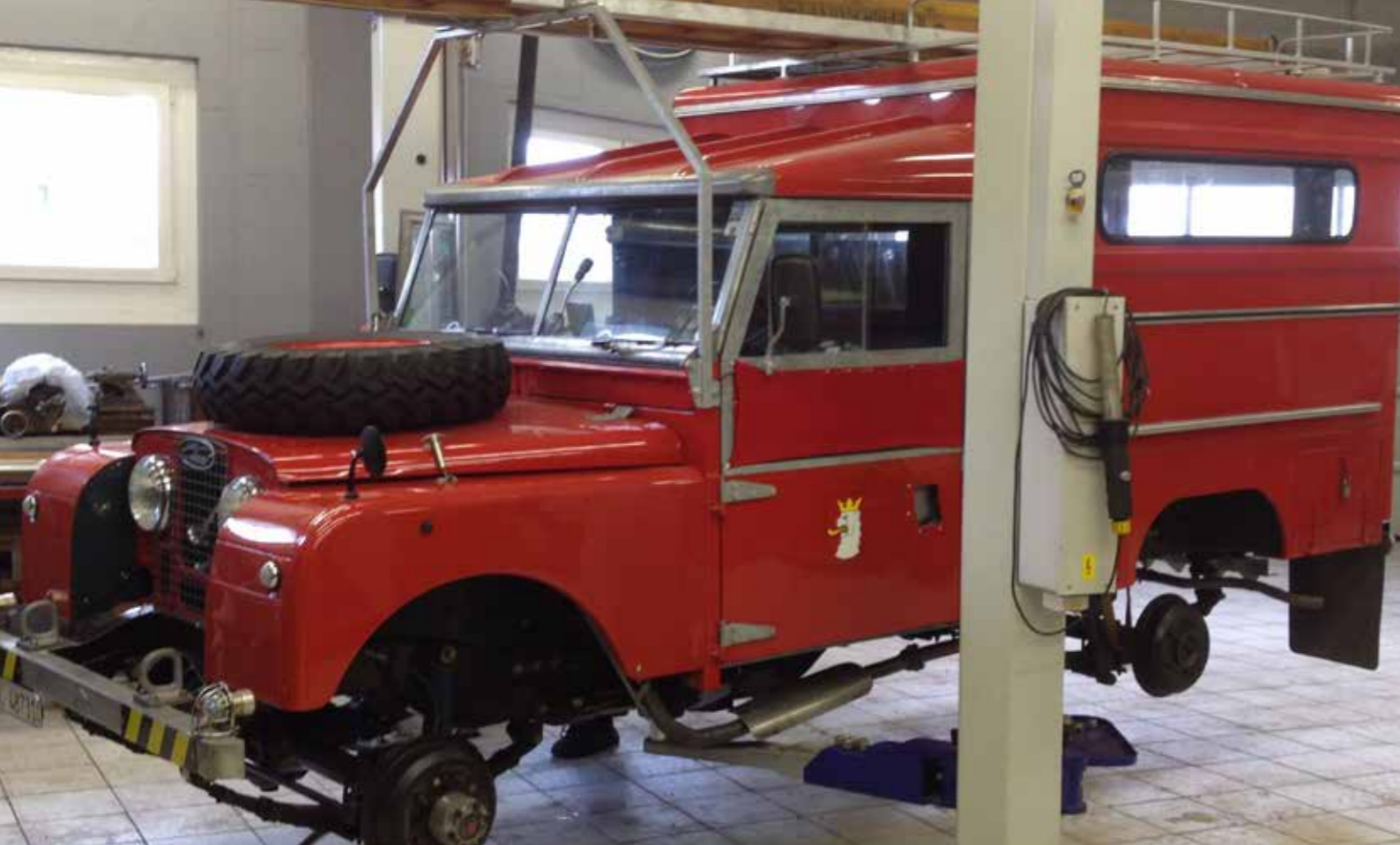
Wechsel der Bremsflüssigkeit Vor der periodischen MFK-Prüfung (nach sechs Jahren) wurde bei Heinz Degen in Augst BL die Bremsflüssigkeit ausgetauscht
