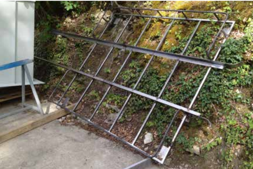
Der Dachträger wurde anhand von Zeichnungen neu konstruiert. Jörg war beim Schweißen voll in seinem Element.
